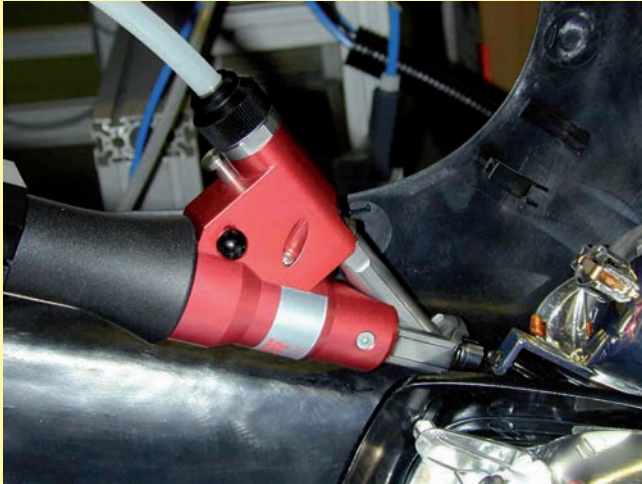
Scheinwerfermontage in Rollerverkleidungen
