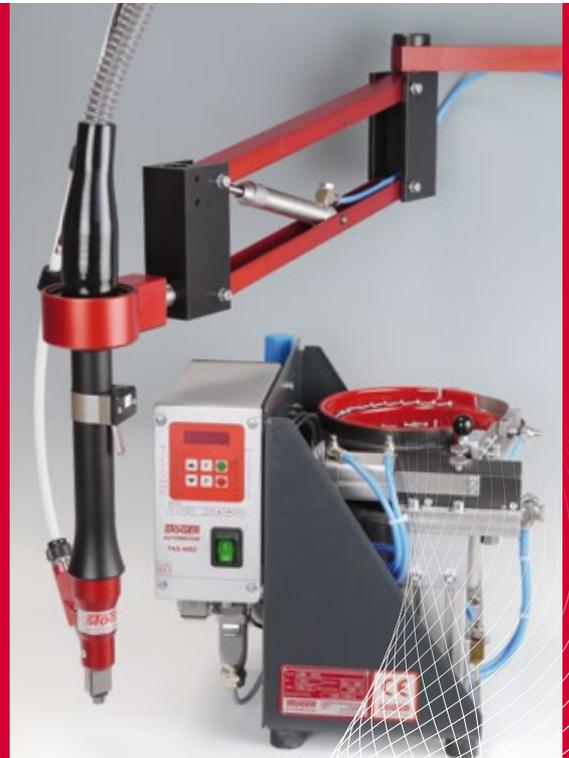
Beide Serien können bei Bedarf, z.B. beim Schrauben an schwer erreichbaren Schrauborten mit einem Vakuummodul ausgestattet werden.
