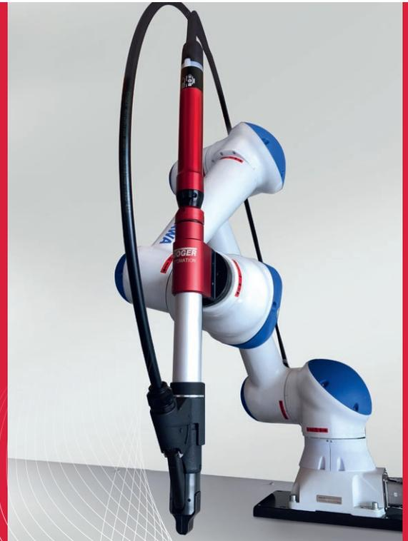
Für schwer zugängliche Schrauborte kann die Einheit mit einem Vakuummodul ausgestattet werden.
