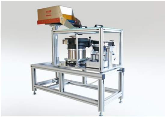
Untergestell und Nachfüllbunker
