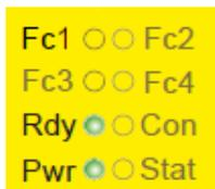
Nach dem Einschalten der Versorgungsspannung leuchtet die **Pwr**-LED dauerhaft.
