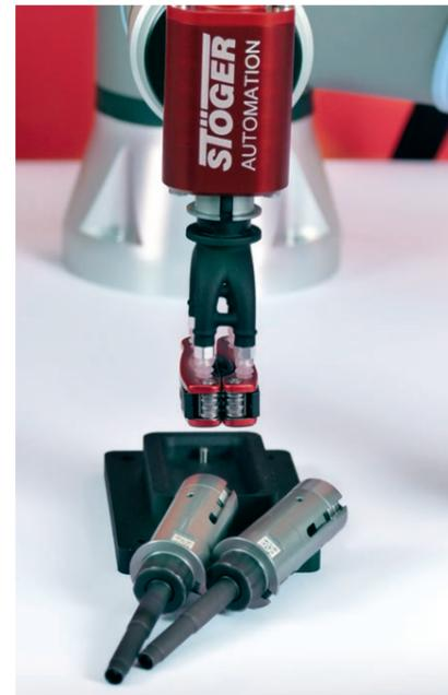
Sauggreifer und zwei Schraubwerkzeuge. Auf den Werkzeugen sind die Prüfcodes für die Leseinheit angebracht.
